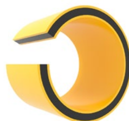
МУЛЬТИПЛЕКС III ПРО Труба 3-х слойная с соэкструзионными слоями. Наружный жёлтый ПЭ100RC, средний чёрный ПЭ100, внутренний жёлтый ПЭ100RC с защитным покрытием ПРО.
