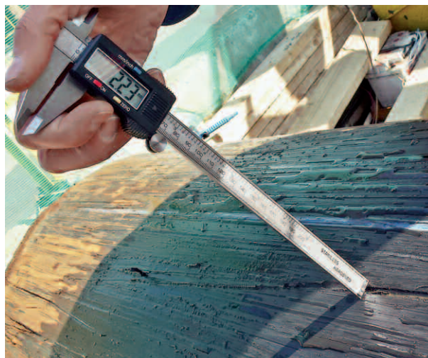
Рисунок 7. Замер глубины царапин на образце № 1.
