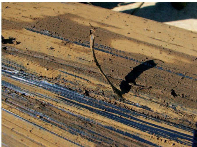
Рисунок 9. Заусенец на поверхности образца № 1.
