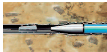
Разрушение ветких труб с одновременной заменой
