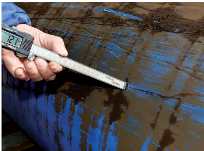
Рисунок 8. Замер глубины царапин на образце № 2.
