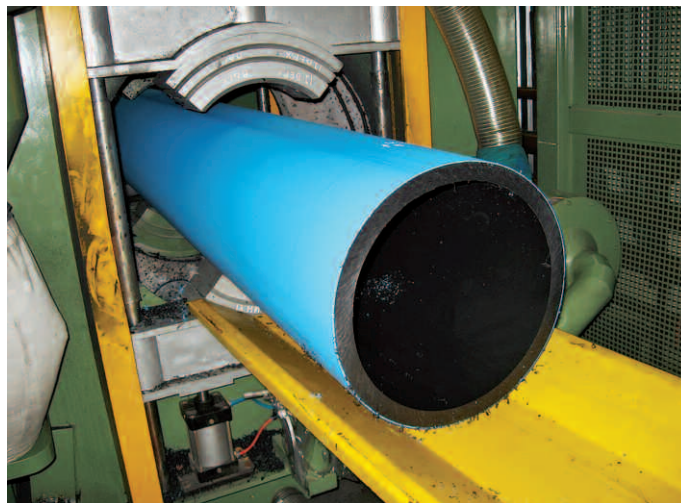
Рисунок 1. Нанесение защитного покрытия методом соэкструзии.
