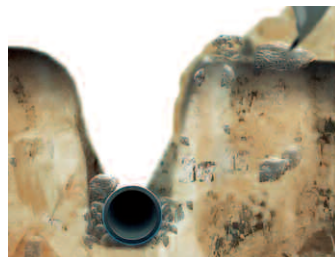
Траншейная укладка без песчаной засыпки
