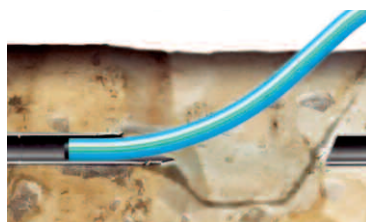
Релайнинг (протаскивание трубы в трубу)
