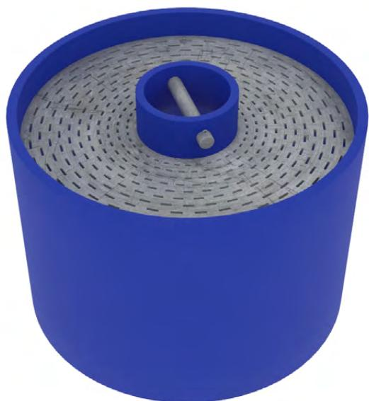
В центральной части ЛОС РГК 2,5 установлен съемный фильтрующий элемент. Жидкость проходит сквозь него сверху вниз. Материал абсорбирует взвешенные частицы и масло. Фильтрующий элемент легко заменяется при помощи манипулятора. Может быть регенерирован или заполнен новым сорбентом.
