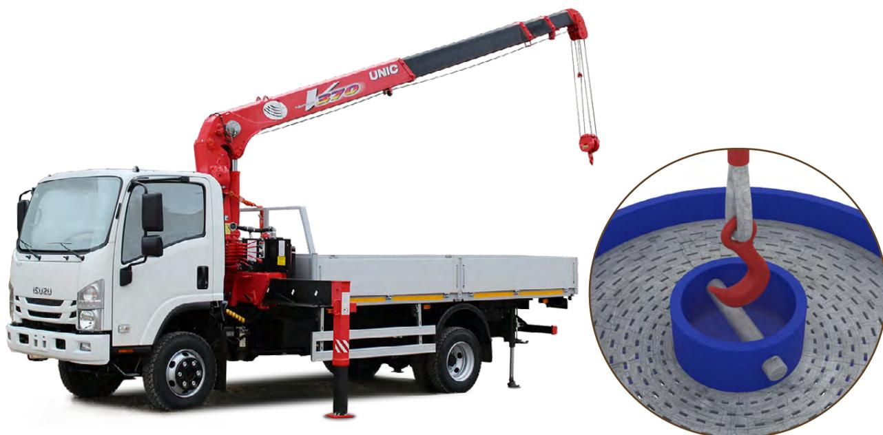
Фильтр-контейнер извлекается из корпуса ЛОС РГК 2,5 при помощи крана-манипулятора. Вес сухого фильтра – 70 кг. Вес фильтр-контейнера, извлекаемого из заполненного стоком ЛОС, может достигать 250 килограмм.
