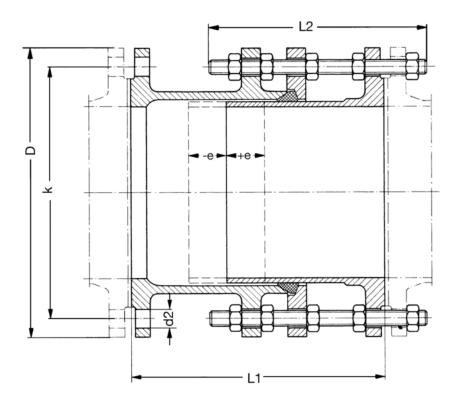
e = +/- 25 мм диапазон регулирования L1 = строит. длина в среднем положении
